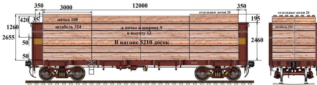
Рис.11. Размещение 16 штабелей из досок, размером 3000x150x35 в полувагоне модели 12-2143
