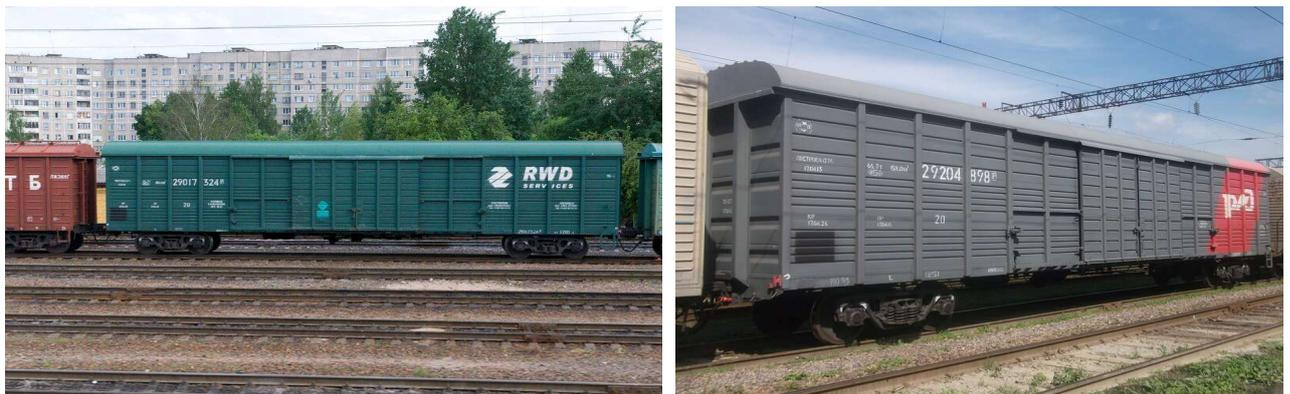
Рис. 7. Крытый цельнометаллический вагон модели 11-1807-01
