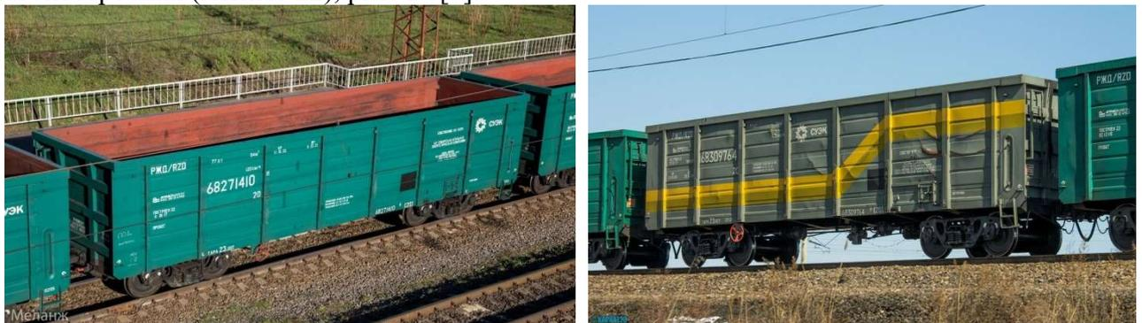
Рис. 10. Полувагон с глухим кузовом модель 12-2143
